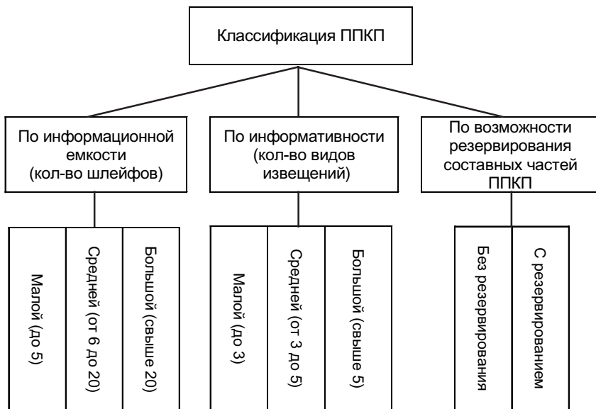
Рис. 2.3. Классификация приборов приемно-контрольных пожарных
